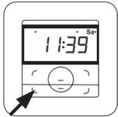
Dank „ Kanal –, werden die Uhrzeit und Minuten bestätigt, System geht in die Einstellung der Tage.
