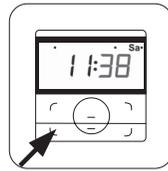
Dank „ Kanal –, wird die Uhrzeit bestätigt, System geht in die Einstellung der Minuten
