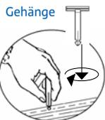
**10** Den Panzer montieren (Abb. 6), indem er über die Welle in die Führungen eingeschoben wird beginnend von der unteren Leiste, und dann die Gehänge anbringen.
