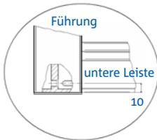
**Achtung!** Wenn wir Rollladen mit automatischem Riegel montieren werden, können wir Kammer der Führungsschiene nicht beschädigen, weil das man zur Einstellung der Bolzen des automatischen Riegels führen kann (Abb. 9).
